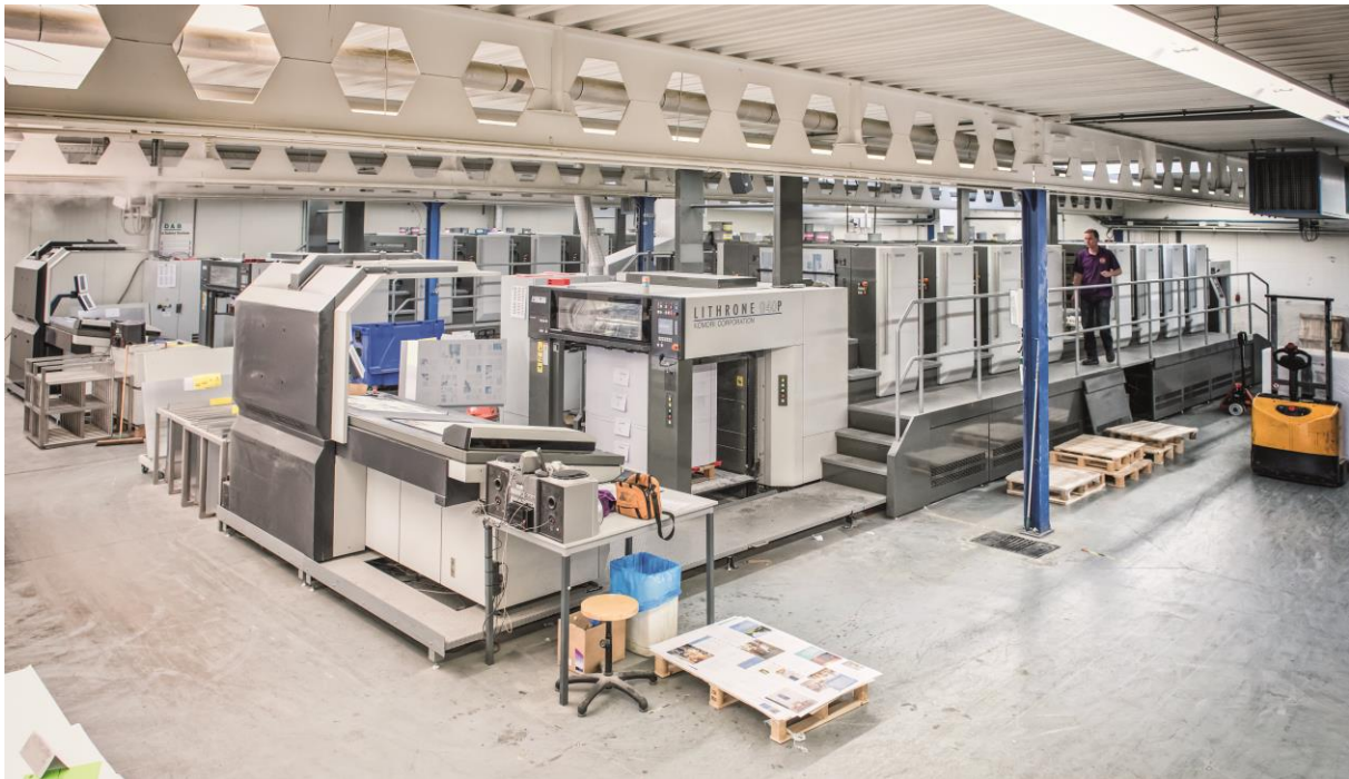
De tweede Komori Lithrone G840 P achtkleuren drukpers op het formaat 70 x 100. Beeld: René Mathon Koele
